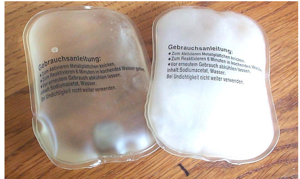
Wärmepacks im ungebrauchten und gebrauchten Zustand
